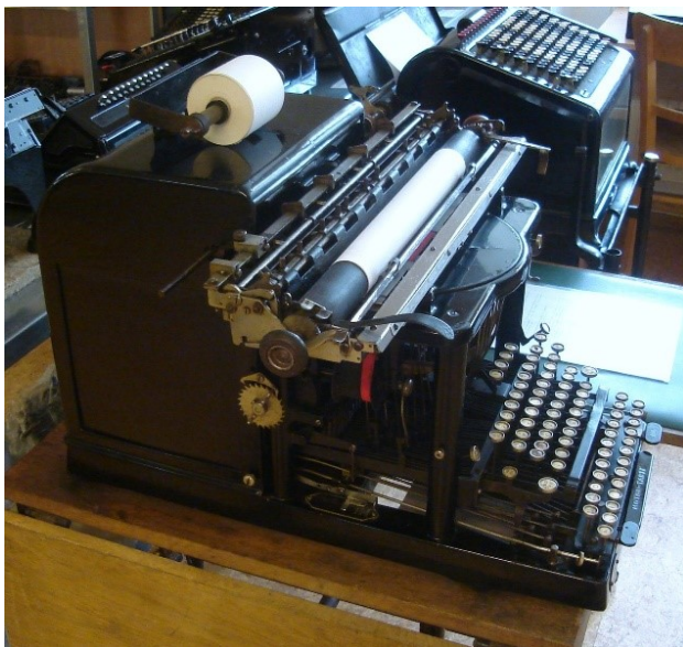
Abb. 2: Burroughs-Moon-Hopkins Fakturiermaschine, Serien-Nr. 938349, Baujahr um 1922; produziert von der Burroughs Adding Machine Company in Detroit, Michigan;
